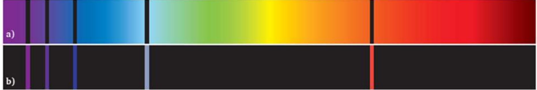
a) Hidrojen absorpsiyon spektrumu b) Hidrojen emisyonu spekturumu
